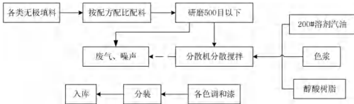
图3.6-4 工业漆（油性漆）生产工艺流程及产污环节
