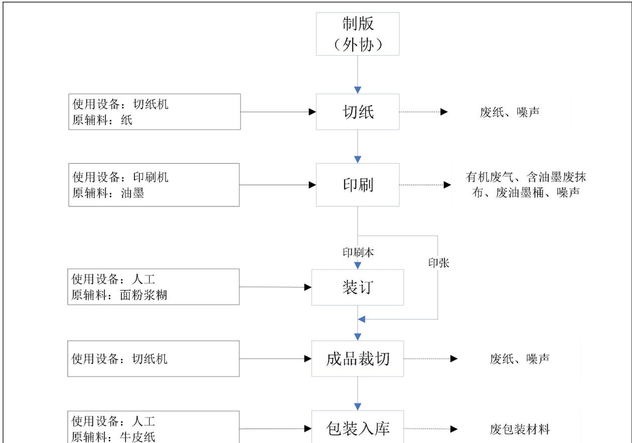
图 2-2 生产工艺流程及产污位置图
